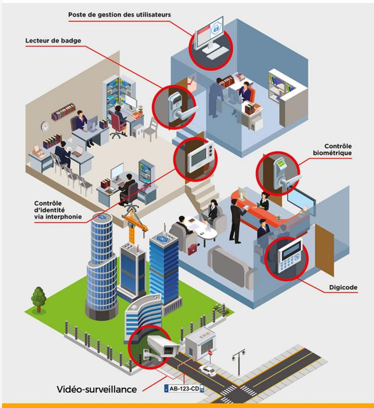
Système de vidéo-surveillance et de contrôle d'accès
